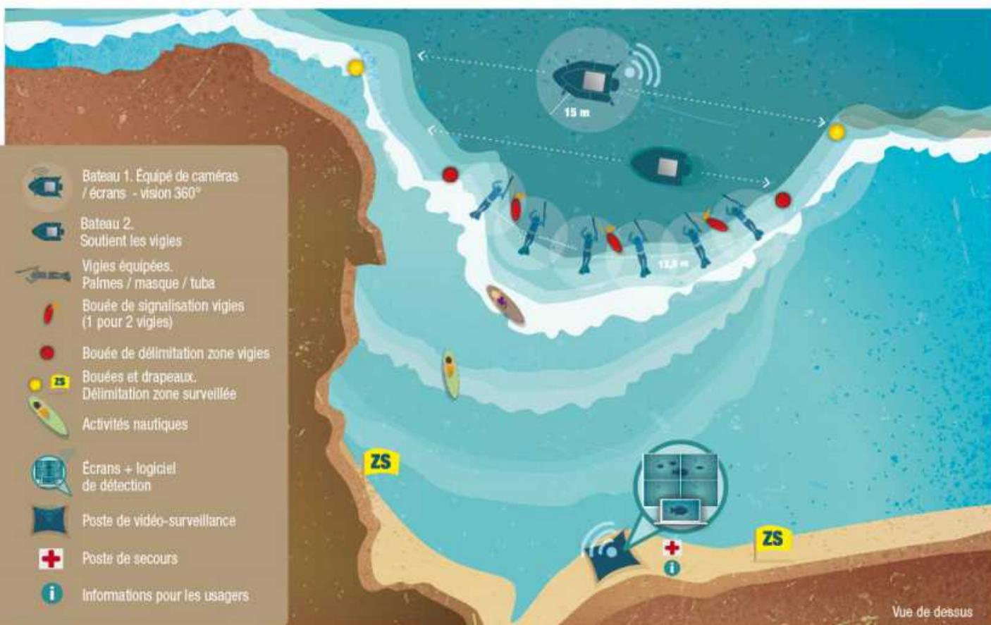
Les caméras sont déployées depuis le bateau (cf. schéma) et en fonctionnement. Les enregistreurs reçoivent les images et les envoient aux écrans de la tente PC par voix HF. Le matériel de secours est opérationnel ainsi que l'ensemble des opérateurs terrestres et embarqués.
