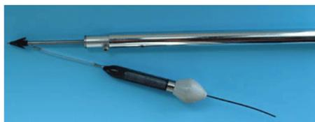
Les balises satellite du type « MiniPAT pop-up » enregistrent à intervalle régulier des paramètres (profondeur, température et lumière) qui permettront de tracer le trajet suivi par le requin.
