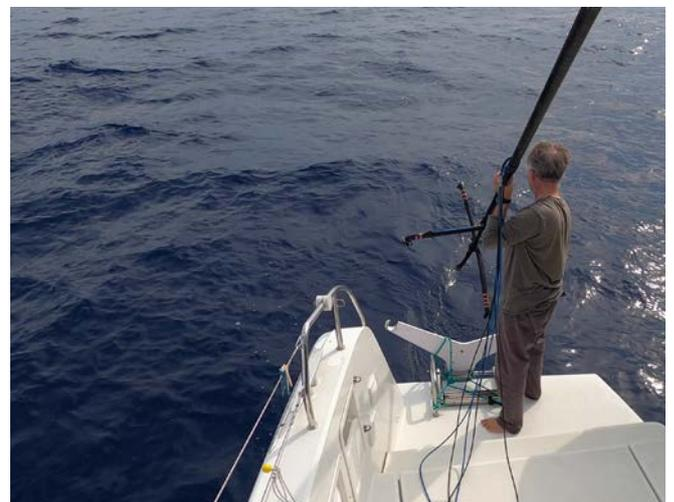
Le Pr Glotin installe *Bagheera*, à l'arrière du bateau, pour enregistrement à 5 hydrophones
