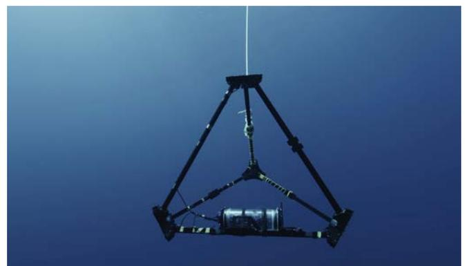
*Tétra*, le système d'enregistrement à 4 hydrophones, plus mobile et autonome, utilisable sur un zodiac.
