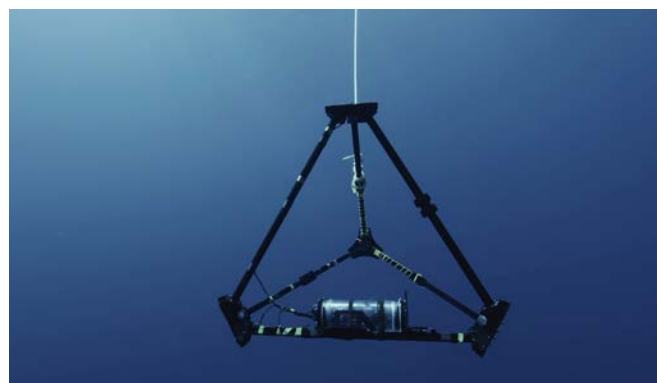
Tétrà, le système d'enregistrement à 4 hydrophones, qui permet de retracer les plongées des cachalots
