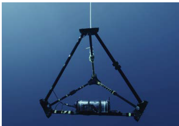
Figure 3.2 : Antenne tétra en immersion par -20 m lors de la mission WhaleWay. Design V. Gies et H. Glotin. Sa version 'penta' intègre un 5 ième hydrophone (crédit F. Sarano / Longitude 181).
