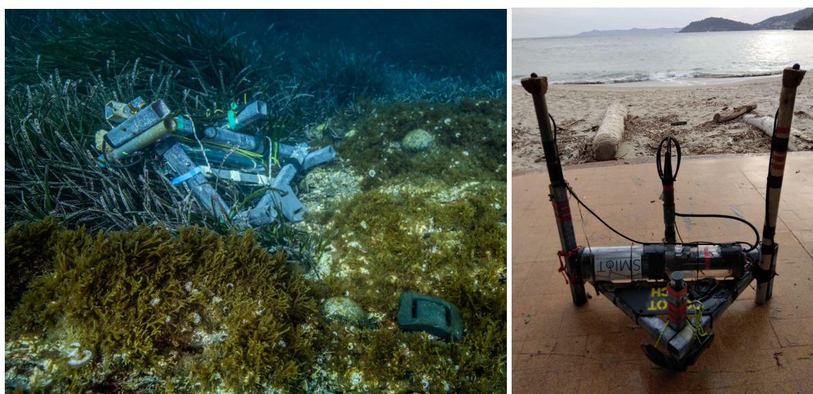
Figure 2.3 : Les antennes de Stochaedes en 2022. Toutes 2 ont été renversées à la dernière pose, suite à un gros temps, ou à une ancre, car nous y avons retrouvé des traces de rouille. (gauche) Rascas renversée malgré ses 10 kg de masse de plomb. (droite) Rayol le 26 mars après avoir été renversée.
