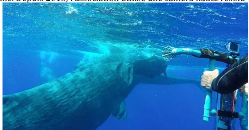
FIGURE 1: DISPOSITIF D'ENREGISTREMENT COMPOSÉ D'UNE GOPRO ET D'UN HYDROPHONE (PHOTOGRAPHIE PRISE PAR LONGITUDE 181)
